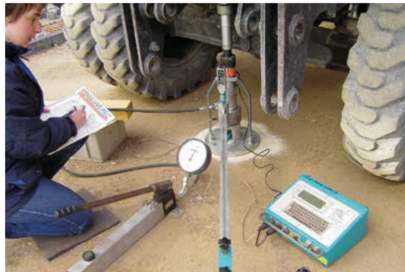
Statischer Plattendruckversuch zur Bestimmung der Tragfähigkeit (Verformungsmodul E_{v2} ) des Bodens
