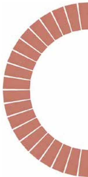
Abb. A5-7: Baumscheibe mit Keilklinkern
