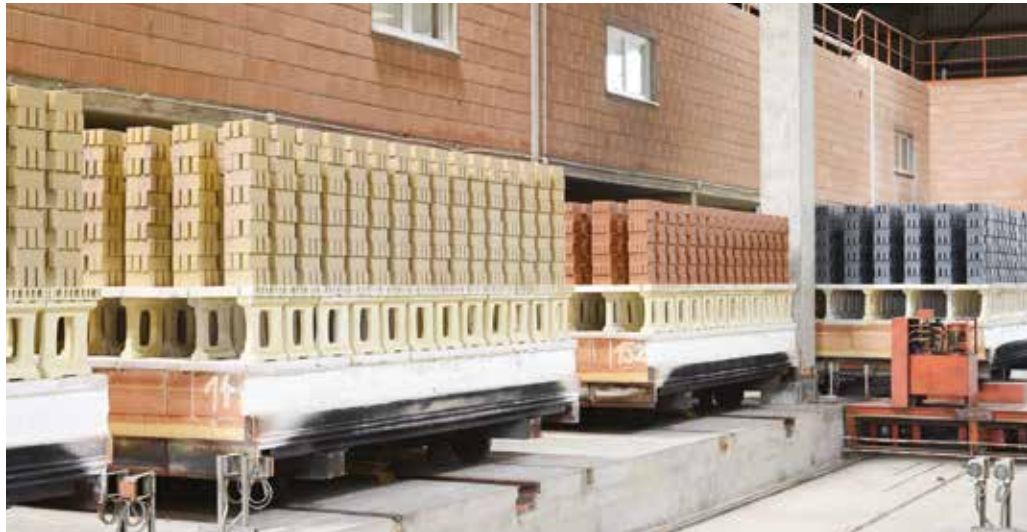
Tunnelofenwagenbesatz mit Pflasterklinker
