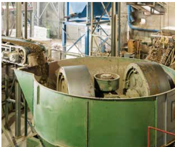
Kollergang, zwei schwere Walzen zerkleinern den Ton
