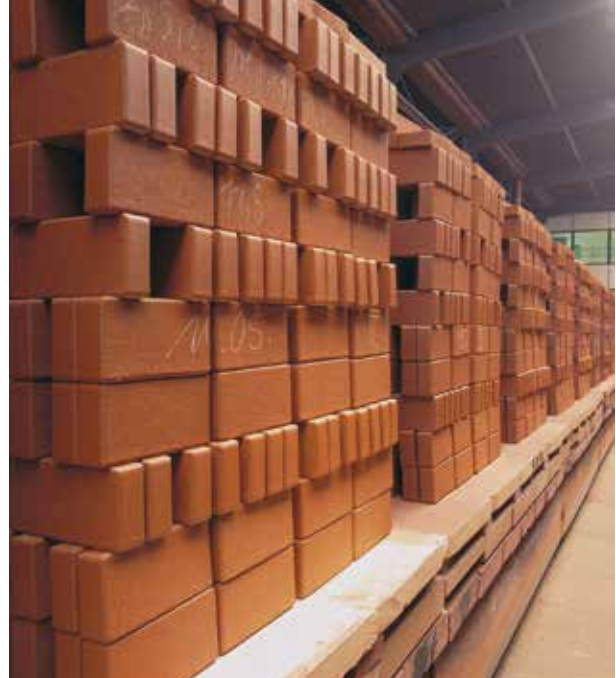
Gebrennte Pflasterklinker nach Verlassen des Ofens
